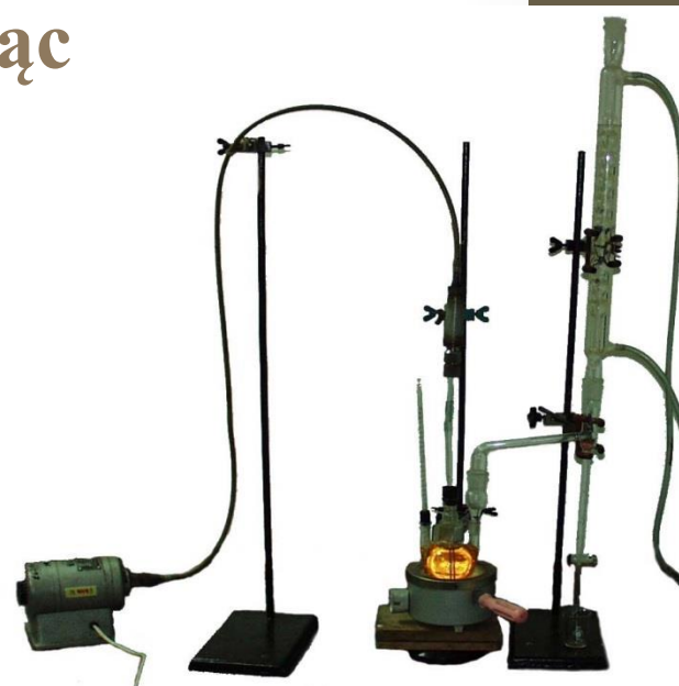
Zestaw do otrzymywania nowych polioli – skala laboratoryjna
