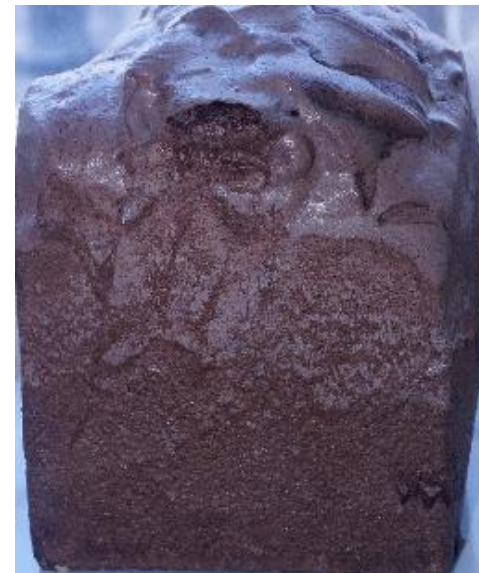
Pianka PUR-PIR zawierająca zmielony makuch z rzepaku
